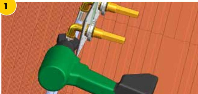
**Bim'Fix est livré avec les coudes déjà fixés sur la platine :** la première étape consiste à raccorder les coudes aux tuyaux d'alimentation (exemple d'un raccord à sertir).
