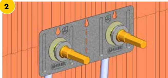
**Mettre la platine en attente sur le mur arrière** (la platine dispose de petites ouvertures permettant la fixation à l'aide d'une vis par exemple). Procéder au test d'épreuve étanchéité.
