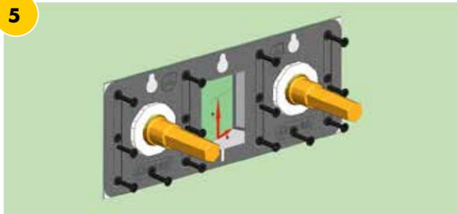
**Détacher et positionner le gabarit de vissage**, visser les vis placés, puis ôter le gabarit.
