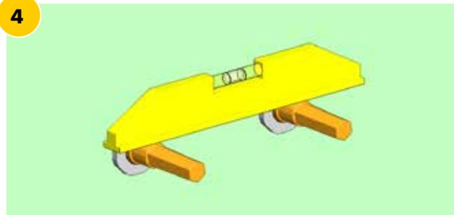
**Visser ensuite le deuxième écrou**, régler le niveau puis bloquer les 2 écrous.
